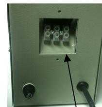
Conexión para foco adicional 20W 12Vcc
