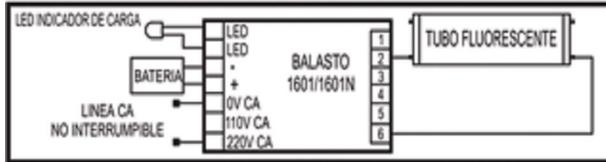
5- SISTEMA DE EMERGENCIA NO PERMANENTE CON LAMPARA 4 PERNOS
