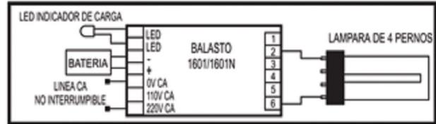
2- SISTEMA DE EMERGENCIA NO PERMANENTE CON REACTANCIA Y ARRANCADOR
